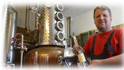
Der anschließende Brennvorgang ist die eigentliche Handwerkskunst des Brenners! Seit jeher wird in der Brennblase die vergorene Maische erhitzt, die dabei entstehenden alkoholischen Dämpfe steigen auf, kondensieren und werden aufgefangen.
